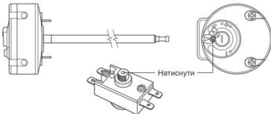
Малюнок 2. Схема розташування кнопки термовимикача. Зовнішній вигляд термовимикача залежить від моделі обладнання
