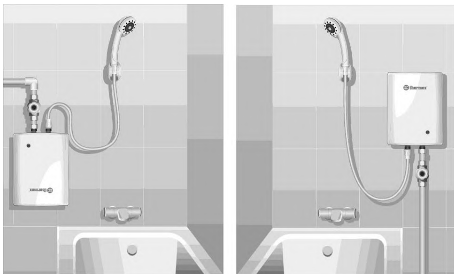
Мал 1. Варіанти встановлення Thermex Surf3500, Surf 5000 і Surf 6000
